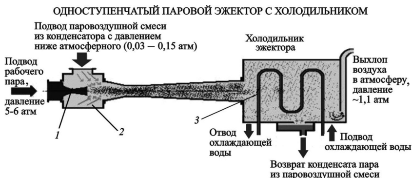
Рис. 9.5. Принципиальная схема парового эжектора: 1 – сопло Лавалья, 2 – камера смешения, 3 – диффузор
