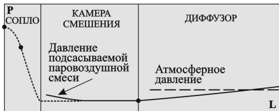
Рис. 9.6. Изменение давления по длине эжектора
